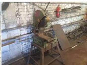
Вот на таком станке мы режем с минимальной погрешностью 1 мм швеллера
