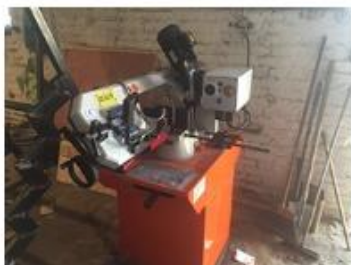
Станок, на котором с минимальной погрешностью до 1 мм мы режем металл для каркасов лестниц
