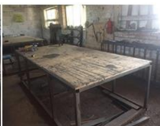
Это третий стол на котором изготавливаются каркасы лестницы закрытого типа
