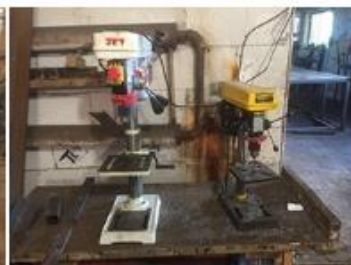
Вот на таких станках мы делаем отверстия для ступеней на металлокаркасе лестниц
