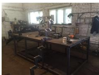
Это второй стол, на котором изготавливаются каркасы лестниц открытого типа
