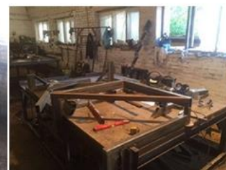
Это четвертый стол на котором изготавливаются лестничные каркасы
